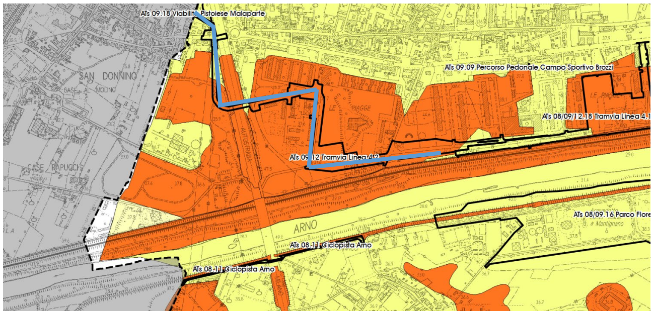
FIGURA 4.1: CARTA DI PERICOLOSITÀ SISMICA CON TRACCIATO IN BLU (PS)
